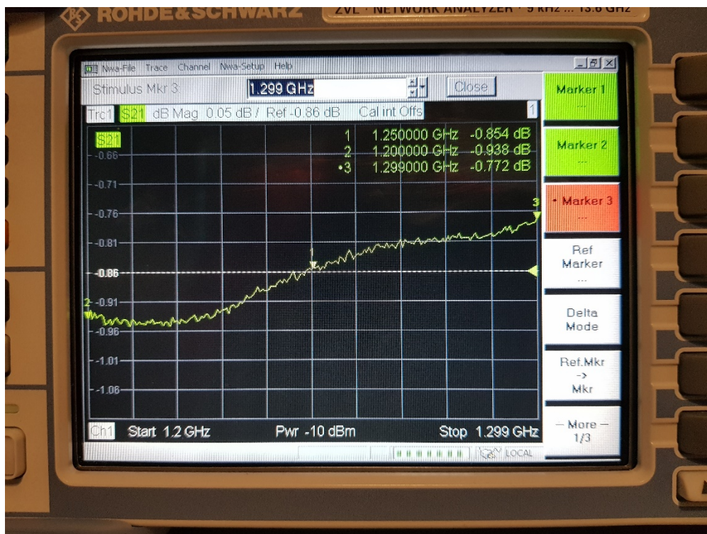
Fig. 9 – Perdita d'inserzione del filtro tra i 1200 e i 1299MHz, <1dB
